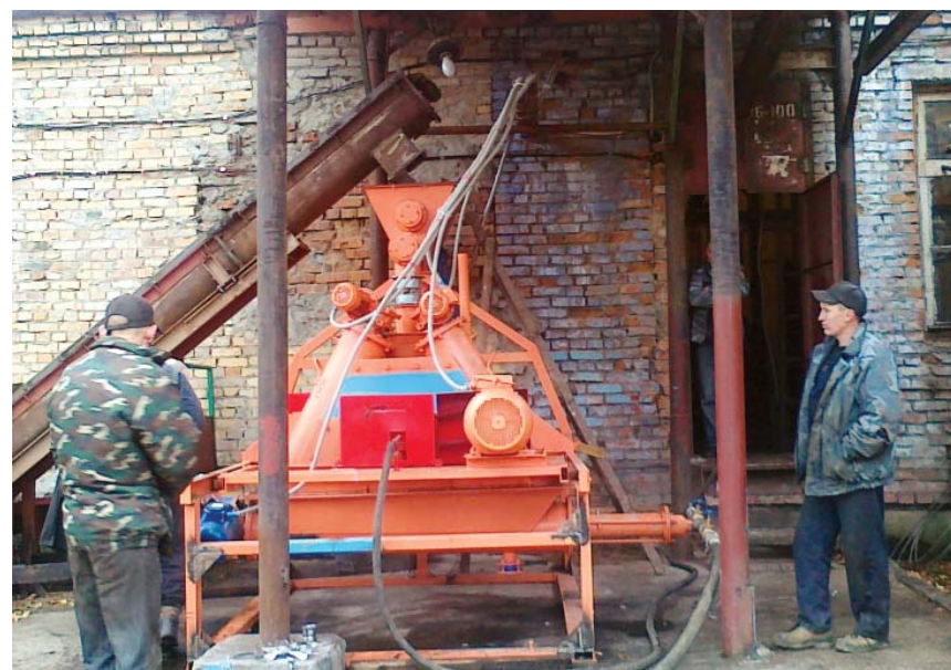
Рис. 1. Гидроударный узел мокрого помола: перед отправкой Заказчику (вверху) и смонтированный силами Заказчика (внизу)
