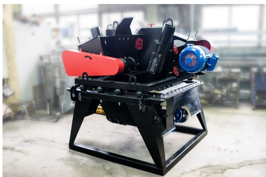
Узел мокрого помола
