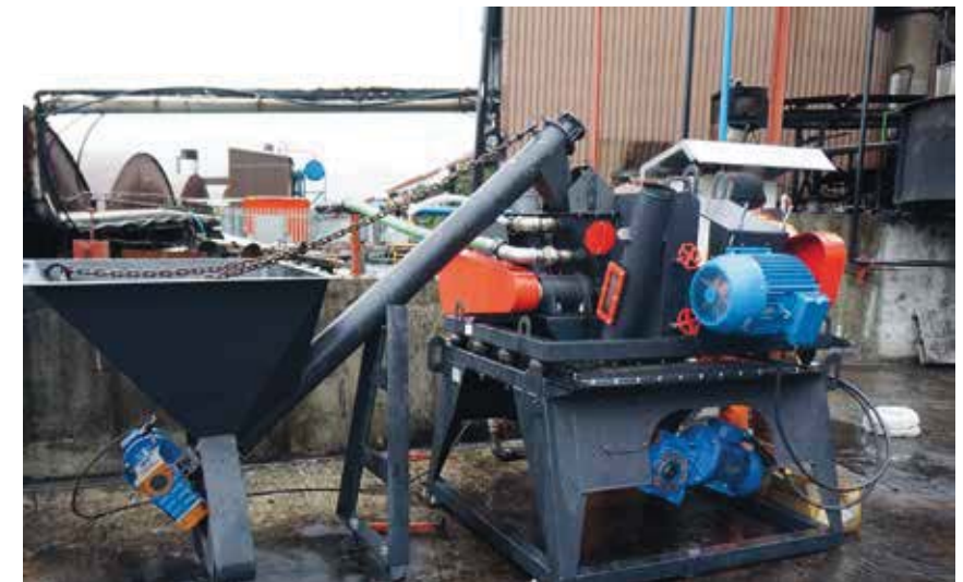
Рис. 2. ГУУМП - гидроударный узел мокрого помола
