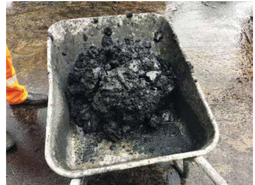
Рис. 1. Исходное сырьё – смесь фильтр-кека различных марок, иногда с добавками нефтяного кокса
